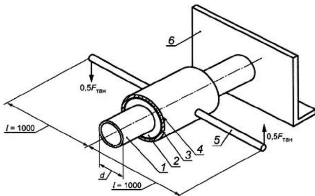
1 - стальная труба; 2 - изоляция из ППУ; 3 - труба-оболочка из полиэтилена;
