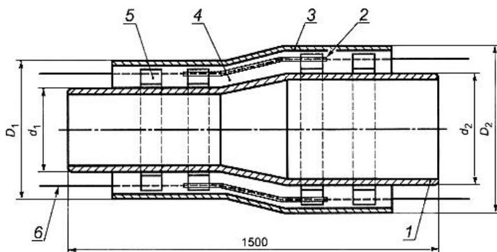
1 - стальная труба; 2 - электроизоляционная трубка (для труб со стальной оболочкой); 3 - оболочка;
