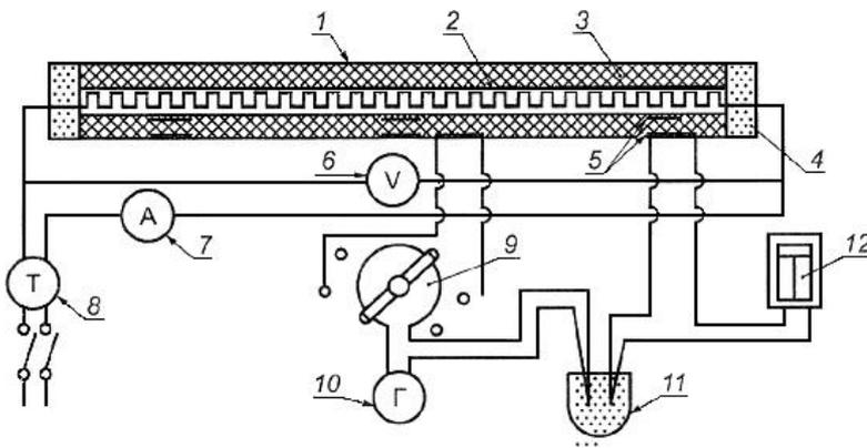
1 - стальная труба; 2 - электронагреватель; 3 - испытуемый материал; 4 - охранный секция;
