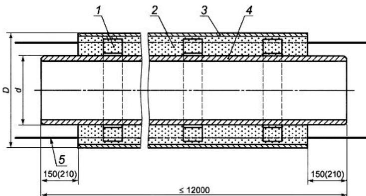
1 - центрирующая опора; 2 - изоляция из ППУ; 3 - труба-оболочка; 4 - стальная труба;
