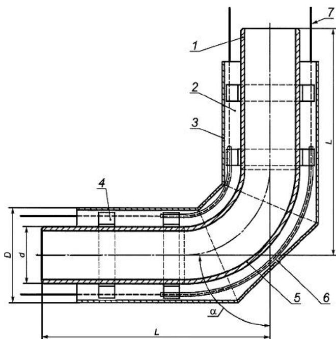
1 - стальная труба; 2 - изоляция из ППУ; 3 - оболочка; 4 - центрирующая опора;
