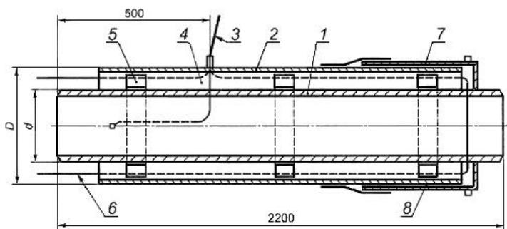
1 - стальная труба; 2 - оболочка; 3 - кабельный вывод; 4 - изоляция из ППУ; 5 - центрирующая опора;
