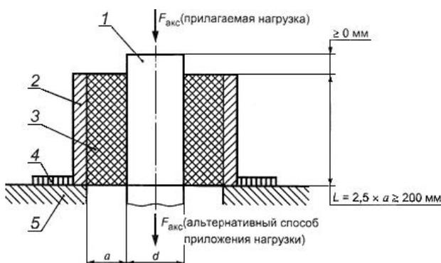
1 - стальная труба; 2 - труба-оболочка из полиэтилена; 3 - изоляция из ППУ;
