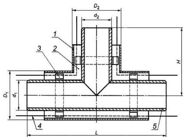
1 - оболочка; 2 - изоляция из пенополиуретана; 3 - центрирующая опора;
