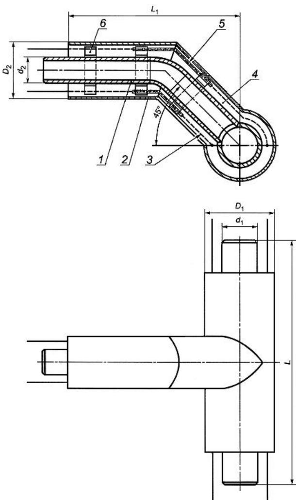
1 - стальной отвод; 2 - оболочка; 3 - проводник-индикатор системы ОДК; 4 - изоляция из пенополиуретана;
