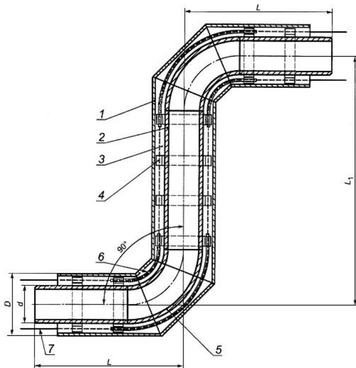
1 - оболочка; 2 - стальная труба; 3 - изоляция из ППУ; 4 - центрирующая опора;
