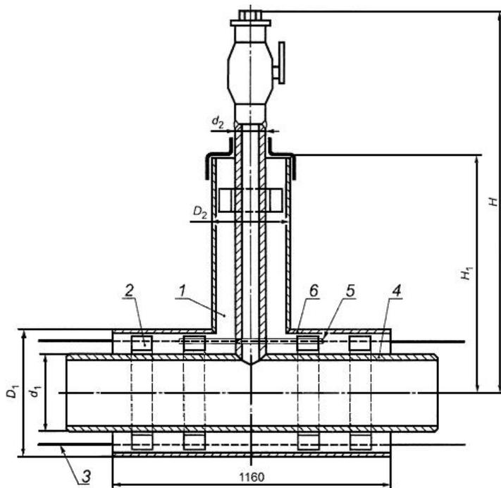
1 - изоляция из ППУ; 2 - центрирующая опора; 3 - проводник-индикатор СОДК;
