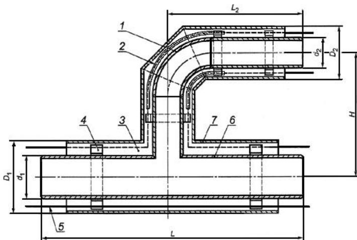
1 - стальной отвод; 2 - электроизоляционная трубка (для труб со стальной оболочкой); 3 - изоляция из ППУ;
